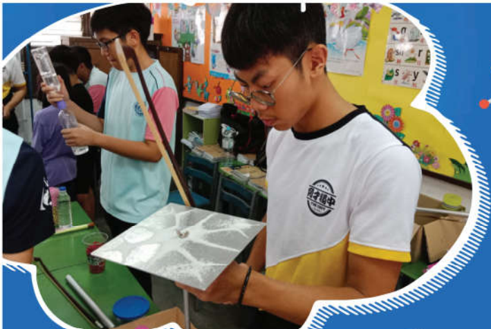
刘庭勇同学利用铝板演示克拉尼图形，当拉动弓弦时，金属板产生振动，使金属板上的盐排列出对称的美丽图案。
